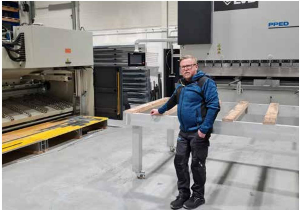
*Firmenchef Johann Maierhofer in der neuen Produktionshalle vor der Abkantpresse mit 260 Tonnen Presskraft und der Tafelschere, die perfekt aufeinander abgestimmt sind und absolute Präzision in der Metallbearbeitung gewährleisten.*
